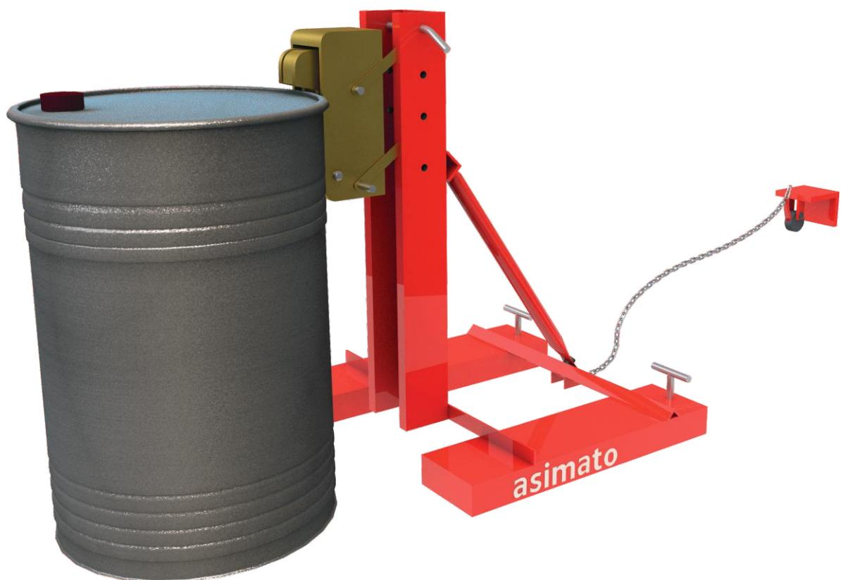
55 galonluk çelik varil ve 210 litrelük plastik varillerin taşınması için kullanılır. Hidrolik veya elektrik bağlantısı olmadan kolayca taşıma yapılabilir. Sadece forklift ile kullanılabilir. Otomatik sıkma mekanizması sayesinde operatör sürücü koltuğundan kalkmadan varılı tutup taşıyabilir, kaldırabilir.
